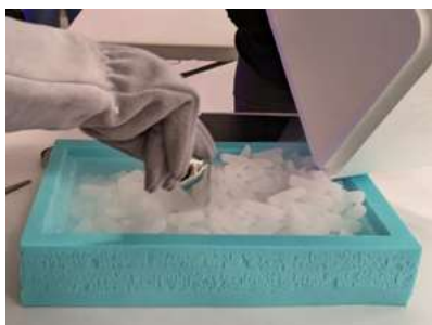
Figura 21. Utilización del hielo seco para la cámara de niebla.
